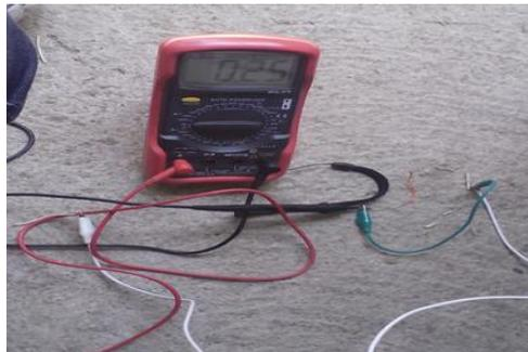
Figura (7). Medición de amperaje
